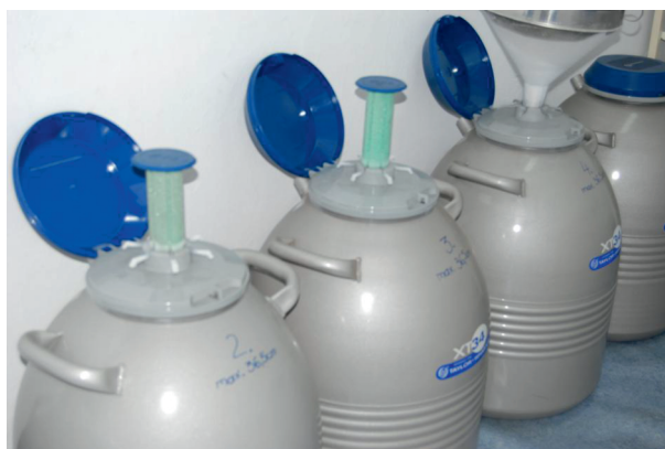
Fot. 6. Naczynia Dewara z próbkami przechowanymi w ciekłym azocie (N. Łukaszevska-Skrzypniak)
