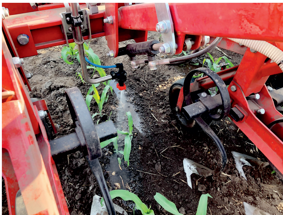
Fot. 1. Opryskiwanie w rzędzie za pomocą systemu SprayKit zamontowanego na pielniku mechanicznym EC-Weeder Photo 1. In-row spraying using the system SprayKit mounted on the EC-Weeder mechanical hoe
